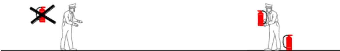
Una volta usato, l'estintore va sostituito con uno identico pieno.
