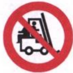
Vietato ai carrelli di movimentazione
